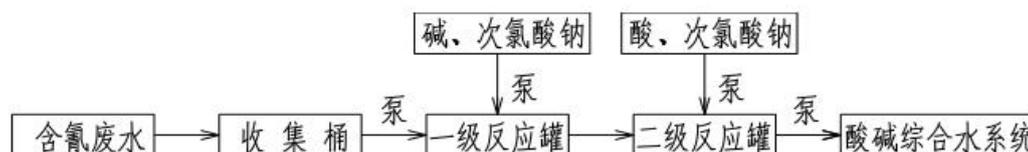
图 3-4 含氰废水处理工艺流程
