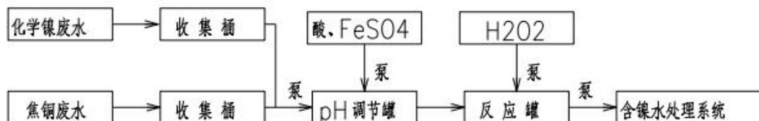
图 3-5 化学镍、焦铜废水处理工艺流程
