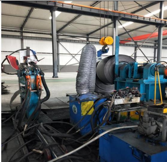
移动式焊接烟尘净化器
