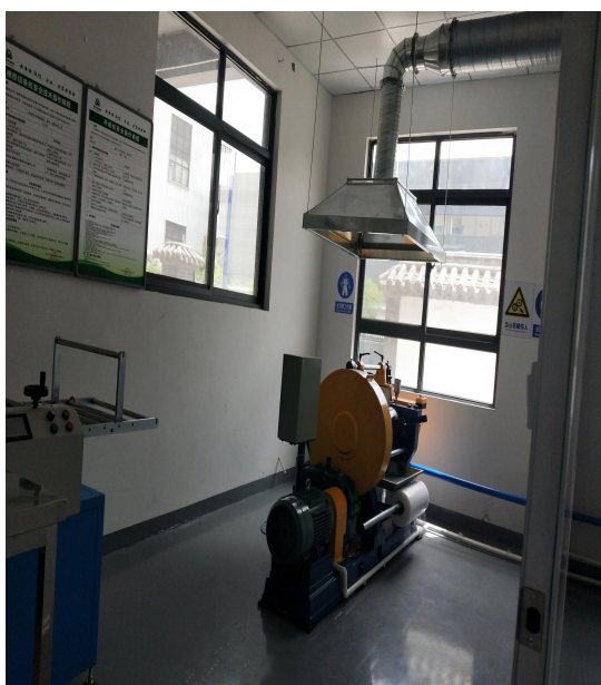
实验室开炼机集气罩
